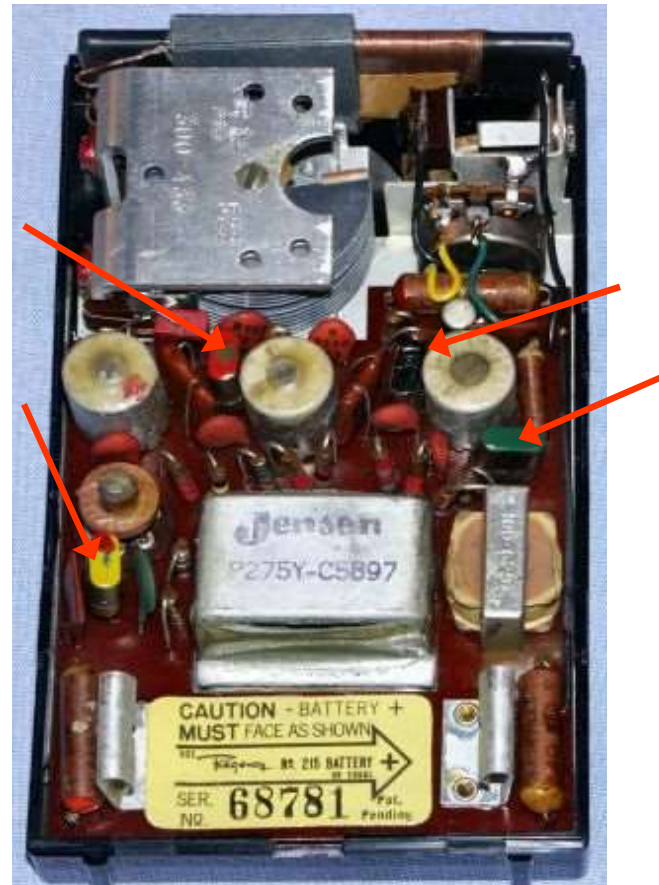
Première radio (4 transistors), Regency TR1, 1954
